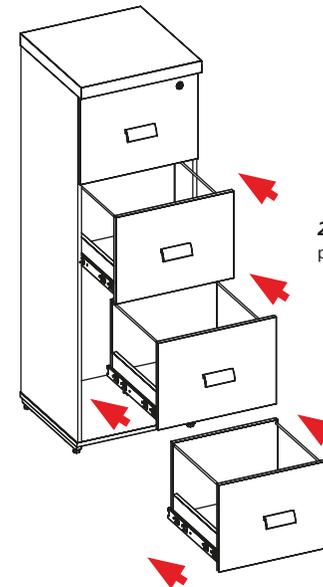
**2.3** Com a corredeira telescópica recuada encaixe a gaveta até o final e repita o processo nas demais gavetas separadamente para finalizar a montagem.
