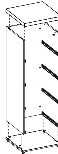
**2.2** Posicione o tampo e a base e fixe utilizando uma chave philips
