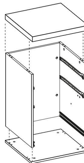
**2.2** Posicione o tampo e a base e fixe utilizando uma chave Philips e Allen para a base
