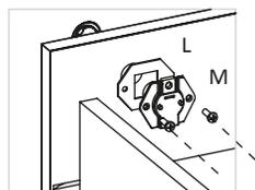
Fixe as corredeiras Roldanas na parte inferior laterais da gaveta utilizando o parafuso **3,5x12 H**
