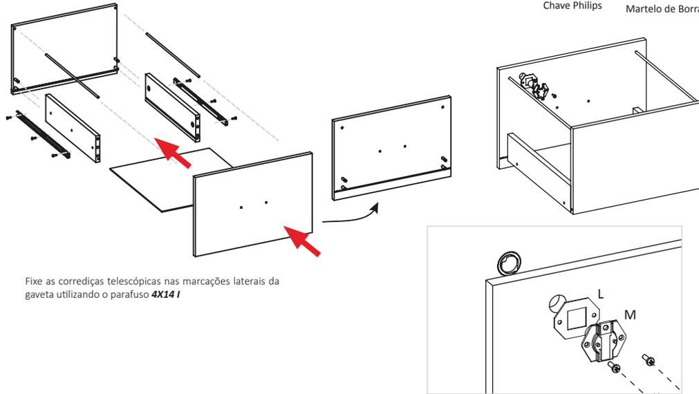
Fixe as corredeiras telescópicas nas marcações laterais da gaveta utilizando o parafuso **4x14 I**
