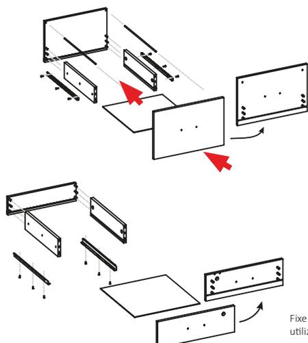
Fixe as corredeiras telescópicas nas marcações laterais da gaveta utilizando o parafuso **4x14 I**
